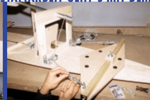
... über bewegliche Seilrollen an der Vorderachse fixiert, die ein Gleitlager aus fünf Mini-Rollen hat.
