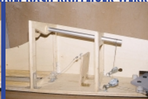
Bremspedal mit Seil, Lenkung. Das Lenkseil ist durch eine einfache Schlaufe am Lenkrohr befestigt und ...
