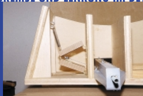
Die Spornbremse wird durch eine Zugfeder gehalten. Durch den Zug am Bremsseil klappt sie nach unten.
